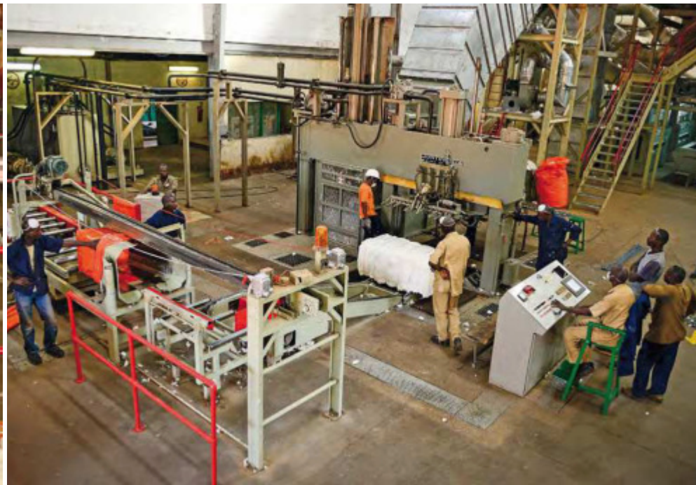
Fertigmachen zum Abtransport: In der Entkörnungsfabrik wird die Baumwolle zu Ballen gepresst und für den Export vorbereitet.
