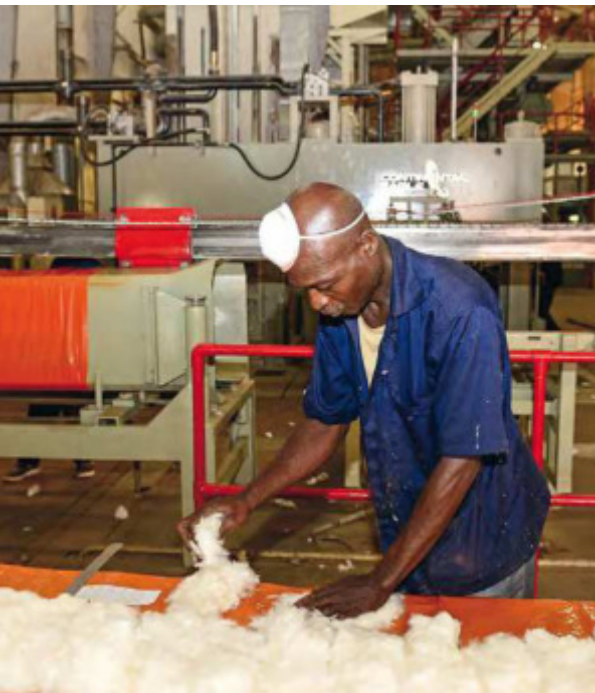
Fertigmachen zum Abtransport: In der Entkörnungsfabrik wird die Baumwolle zu Ballen gepresst und für den Export vorbereitet.
